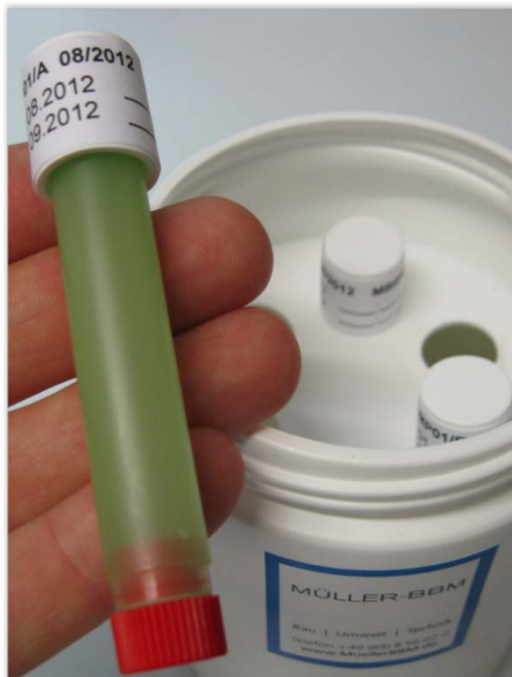
Abbildung 8. NO 2 -Passivsammler mit Witterungsschutzgehäuse (Nahaufnahme).
