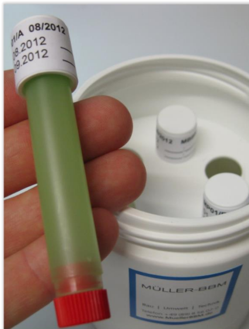
Abbildung 8. NO 2 -Passivsammler mit Witterungsschutzgehäuse (Nahaufnahme).
