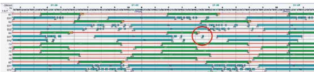
Signalzeitenaufzeichnung (Rotlichtverstoß) an der Kreuzung Schillerstraße/Ebert-Brücke
