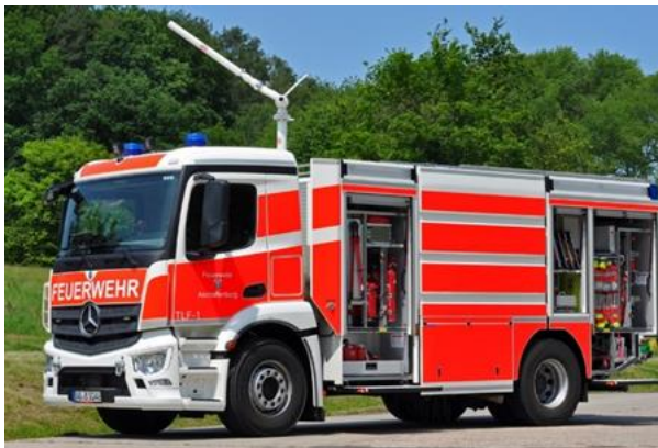
Abbildung 58: Das TLF 4000 verfügt über einen klappbaren Wasserwerfer auf dem Dach. (Ziegler Group, 2019)
